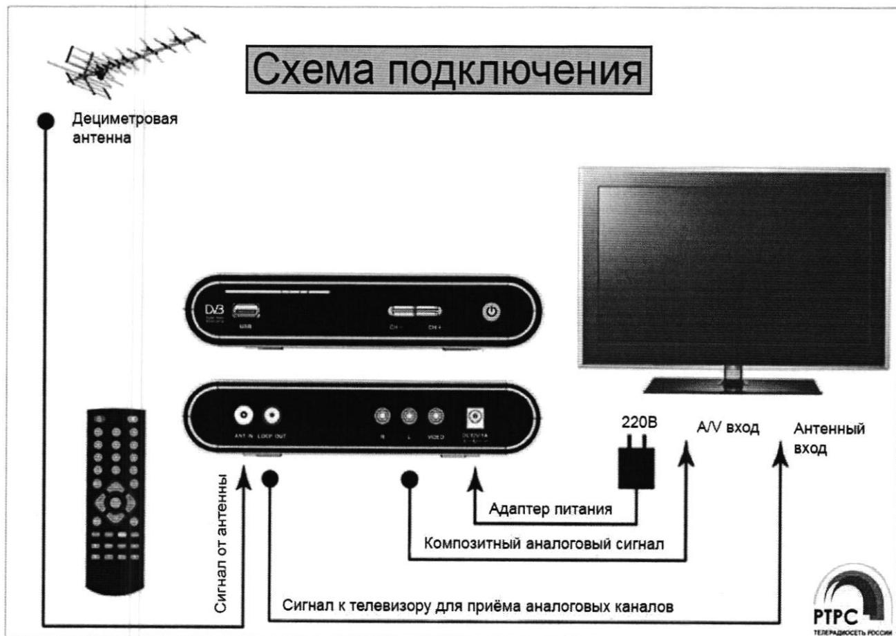
Для этого вам потребуются: телевизор со входом 3RCA, цифровой ресивер с выходом 3RCA, антенна для приёма ТВ сигнала дециметрового диапазона, соединительные провода. После выполнения данных требований и нужных соединений выберите в телевизоре тип входа AVi произведите автоматический поиск каналов в ресивере согласно инструкции к ресиверу.
