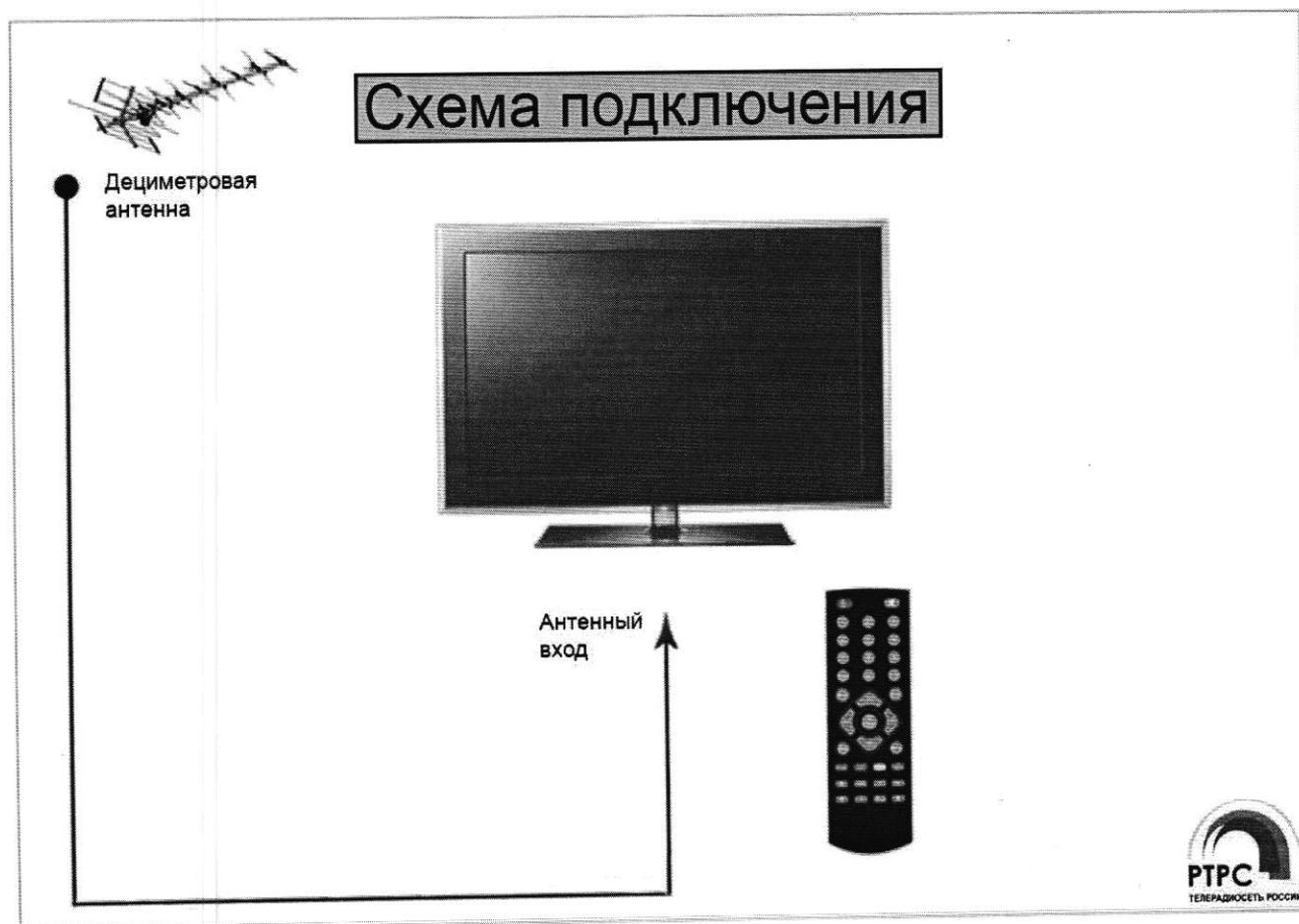
Для этого вам потребуется сам телевизор, антенна для приёма ТВ сигнала дециметрового диапазона и соединительный ВЧ кабель. После выполнения данных требований и нужных соединений выберите в меню телевизора источник изображения «Цифровое эфирное телевидение DVB-T2» и выполните автоматический поиск каналов согласно инструкции к телевизору.
