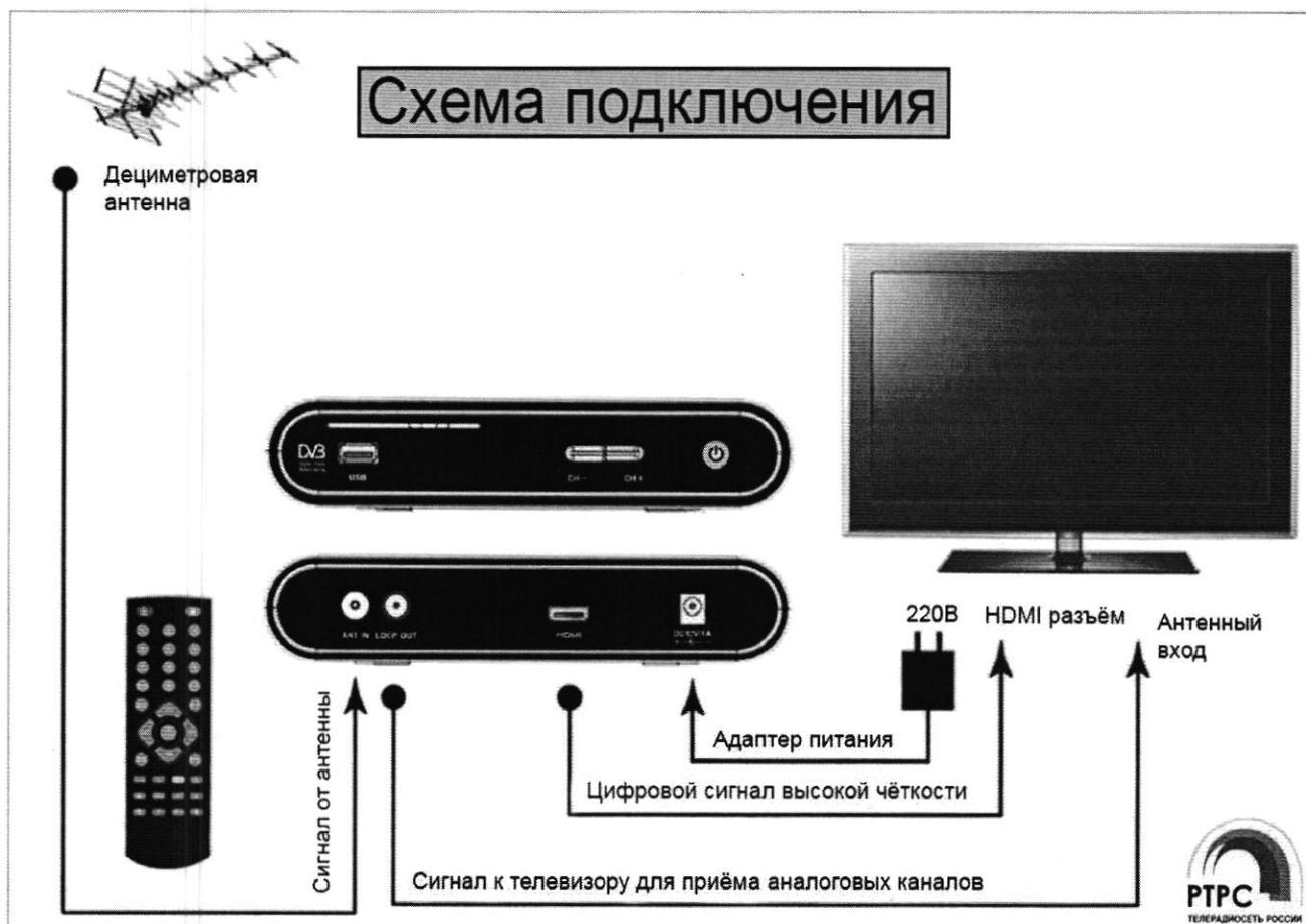
Для этого вам потребуются: телевизор, поддерживающий стандарт высокой чёткости HDMI, цифровой ресивер с поддержкой HDMI, антенна для приёма ТВ сигнала дециметрового диапазона, соединительные провода. После выполнения данных требований и нужных соединений выберите в телевизоре тип входа HDMI и произведите автоматический поиск каналов в ресивере согласно инструкции к ресиверу.
