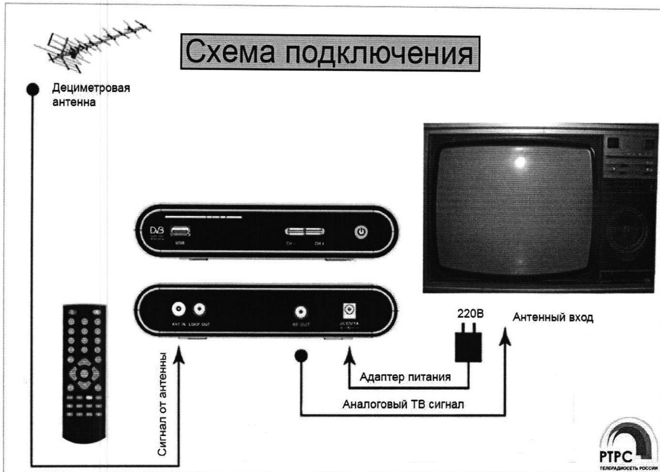
Для этого вам потребуются: любой телевизор, цифровой ресивер с радиочастотным выходом, антенна для приёма ТВ сигнала дециметрового диапазона, соединительные провода. После выполнения данных требований произведите автоматический поиск каналов в ресивере согласно инструкции к ресиверу, автоматическим поиском каналов (если он имеется) выполните поиск канала с ресивера. При этом возможность просмотра аналоговых каналов исчезает (если она не предусмотрена ресивером).
