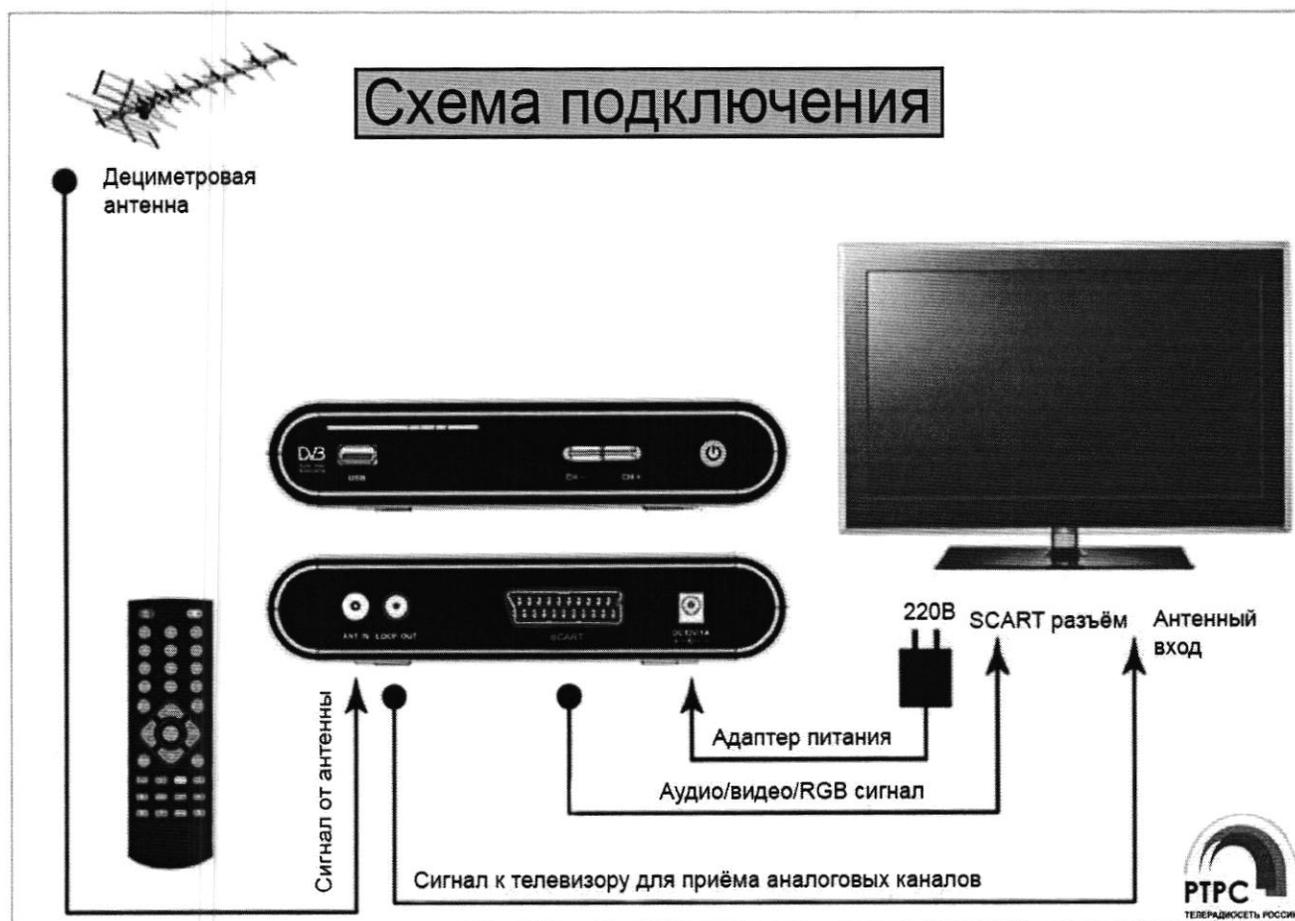
Для этого вам потребуются: телевизор с SCART разъёмом, цифровой ресивер с разъёмом SCART, антенна для приёма ТВ сигнала дециметрового диапазона, соединительные провода. После выполнения данных требований и нужных соединений выберите в телевизоре тип входа AVi произведите автоматический поиск каналов в ресивере согласно инструкции к ресиверу.
